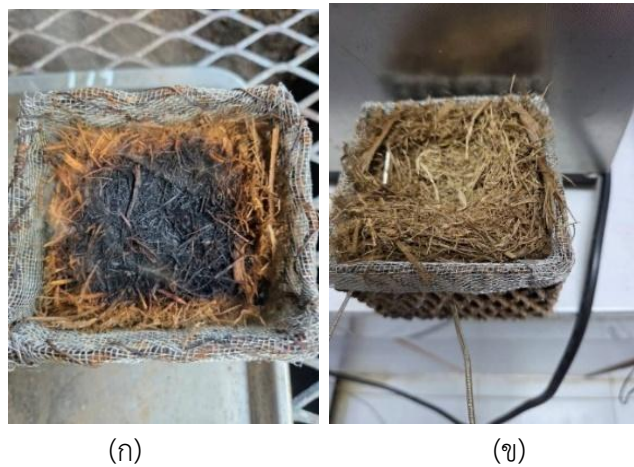
ภาพที่ 3: ลักษณะทางกายภาพชั้นทดสอบทรงลูกบาศก์ (ก) เกิดการลุกไหม้เองที่อุณหภูมิ 193.5^{\circ}\text{C} ข) ไม่เกิดการลุกไหม้เองทดสอบที่อุณหภูมิ 192.5^{\circ}\text{C}
