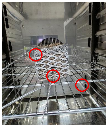
ภาพที่ 2: ตำแหน่งติดตั้งเทอร์มอคัปเปิล K-Type 3 จุด
