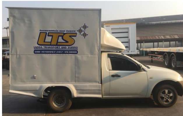
ภาพที่ 5 รถกระบะบรรทุกเครื่องยนต์ดีเซล ซึ่งจะนำส่วนโครงสร้างไปดัดแปลงเป็นรถยนต์ไฟฟ้าต้นแบบ โดยส่วนเครื่องยนต์จะถูกแทนที่ด้วยมอเตอร์ไฟฟ้า ที่มา: บริษัทขนส่ง ลัดดาทรานสปอร์ต แอนด์ ซัพพลาย
