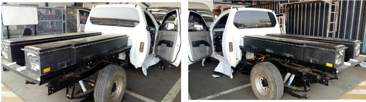
ภาพที่ 8: แบตเตอรี่ที่วางอยู่บนทั้งสองด้านของโครงรถกระบะไฟฟ้าต้นแบบ ซึ่งมีการวางห่างกันเพื่อกระจายน้ำหนักที่ช่วยสมดุลจุดศูนย์ถ่วงของรถ
