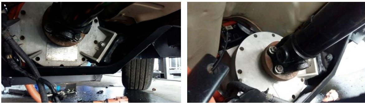
ภาพที่ 9: การเชื่อมต่อเพลาสําหรับขับเคลื่อนล้อหลัง กับมอเตอร์ที่ใช้ขับเคลื่อน ซึ่งอยู่ที่ด้านหน้าตัวรถยนต์ไฟฟ้าต้นแบบ
