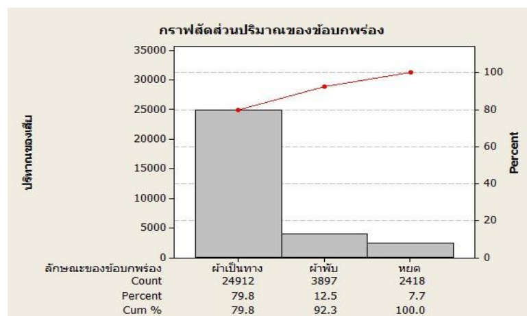
ภาพที่ 1: ปริมาณของลักษณะข้อบกพร่องของเสียที่เกิดขึ้นในช่วงเดือน พ.ย. 2562 ถึงเดือน มิ.ย. 2563
