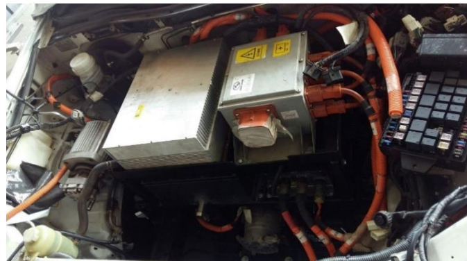
ภาพที่ 10 กล่องควบคุมและระบบ BMS ซึ่งมีหน้าที่รับคำสั่งจากผู้ขับขี่ ควบคุมความเร็วของมอเตอร์ รวมไปถึงการชาร์จประจุแบตเตอรี่
