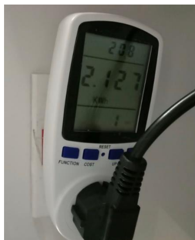
รูปที่ 6: Power meter ที่ใช้เก็บค่าสิ้นเปลืองพลังงานเมื่อมีการชาร์จแบตเตอรี่
