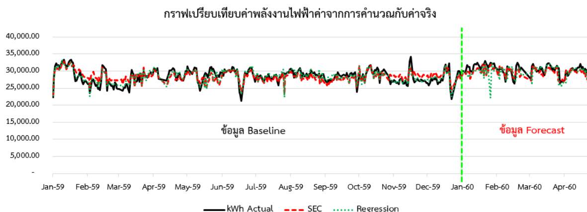
ภาพที่ 3 : กราฟแสดงการพยากรณ์การใช้พลังงานจากสมการพลังงานจำเพาะเทียบกับค่าจริง
