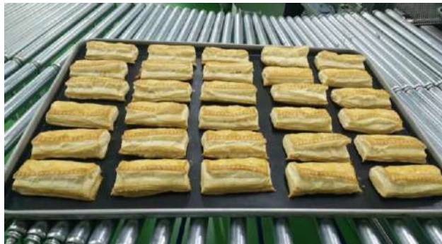
รูปที่ 4: ลักษณะพายเมื่อใช้แรงกดพายที่ 2 บาร์และ 3 บาร์
