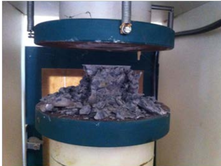
รูปที่ 3: รูปแบบการวิบัติของตัวอย่างทดสอบ
