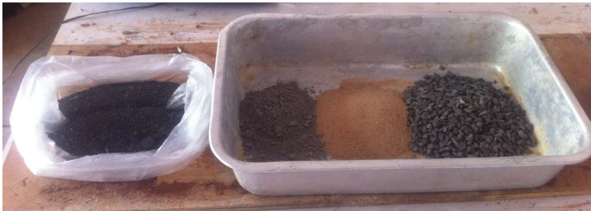
รูปที่ 1: วัสดุที่ใช้ในการผสม (ผงเหล็ก ปูนซีเมนต์ ทราย หิน)
