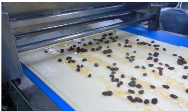
รูปที่ 7: ผลการทดลองการโรยลูกเกตโดยใช้เครื่องจักรโรยลูกเกต
