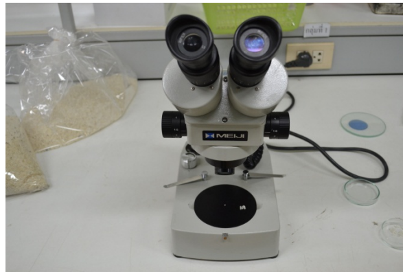
ภาพที่ 4 : กล้องจุลทรรศน์ยี่ห้อMeiji Technology สำหรับวิเคราะห์การแตกหักของเมล็ดข้าวสาร
